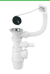
Cet ensemble complet, conçu pour équiper un évier Ø50, 1 bac, comprend une bonde et un siphon classique. Grâce à sa garde d'eau de 50 mm, le siphon est efficace contre les remontées d'odeurs.
