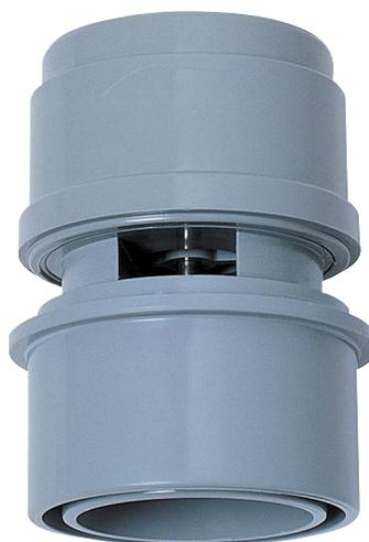
Anti-vide WIRQUIN pour installation verticale. Evite tous les désagréments liés aux dépressions dans les canalisations tel que les bruits, le désiphonage des siphons et les remontées de mauvaises odeurs en supprimant les phénomènes d'aspiration.
